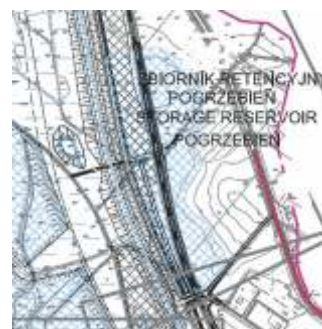
Rys. Zbiornik Pogrzebień – pojemność około 48 tys. m 3
